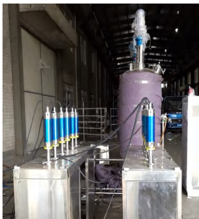
超声波石墨烯循环生产线
