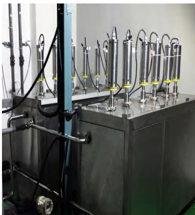
超声波石墨烯循环生产线
