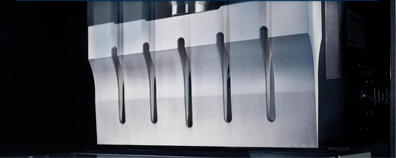
超声波切割是利用超声波的能量，将被切割材料的局部加热熔化，达到切割材料的目的，因此无需锋利的刃口。
