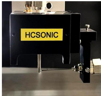
与传统的依靠压力和高速运动将液体粉碎成小颗粒的喷雾头不同，超声波喷头是利用较低的超声波振动能量来进行液体雾化。液体可通过自身重力或低压液泵传送到喷雾头并实现连续或间断性雾化。在不超出限度的情况下，液体雾化量仅由液体的输送量决定。
