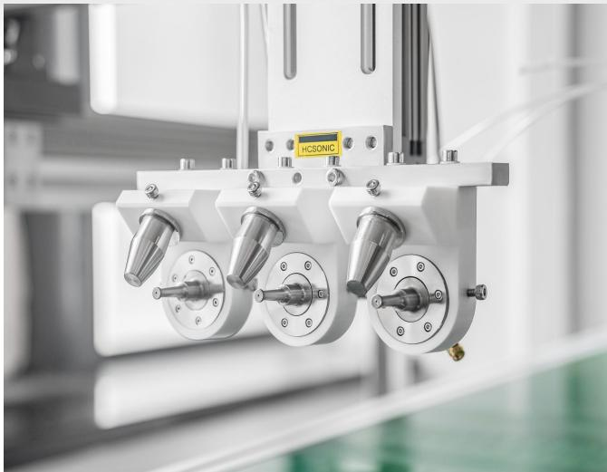
扇形喷涂系统是将HCSONIC独特的超声波雾化喷头与扇形喷嘴所喷出之受控气流结合而成。在雾化面上由超声波所产生之雾滴会立即被气流所带走，形成扇形的喷雾形状。由于气流流速受到控制，所以气流能以高或低撞击力将喷雾射向产品或工件上。
