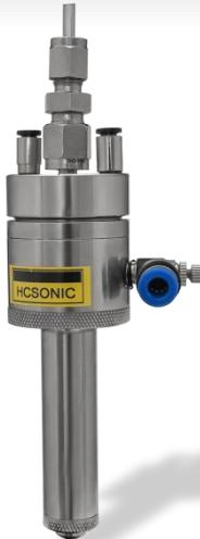
超声波高温热解喷头，采用超声波雾化技术，将溶液或悬浮液均匀雾化后结合氮气喷入管式炉中进行高温热分解制备超细粉体，是喷雾热分解系统中的关键装置。雾化头带有独特的法兰设计，可与各种标准管式炉对接，除此之外，喷头还设有强制冷却结构，同时内嵌温度传感器可实时监测超声喷头工作温度。
