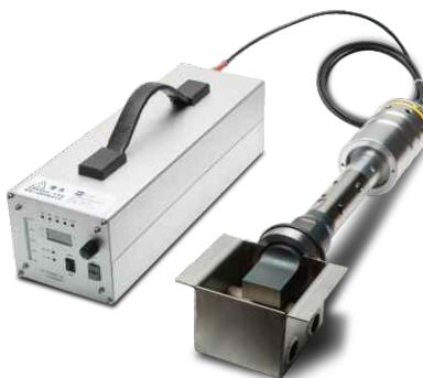
超声波浸焊过程中，一个单独的能量源产生的热量用做熔化填充金属，然后再加入超声波振动能量，熔融的焊料用作超声波振动的传输介质。当将高频振动能量应用于熔融焊接时，在焊接工具表面会产超声空化，以分解和分散表面氧化物。空泡的微泡破裂，清洗焊件表面，使湿润的焊料能与纯金属结合。
