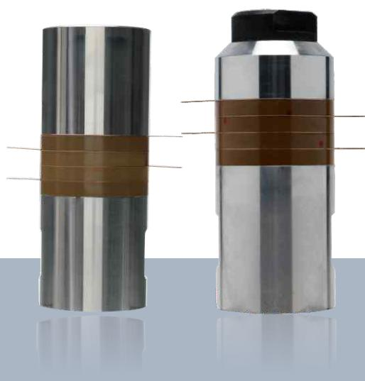
超声波发生器将220V的市电转换为高频电流传递给压电陶瓷，谐振于超声频率的压电陶瓷，由材料的压电效应将电信号转换为线性的机械振动，再通过超声波变幅杆放大（减小）振幅，最终传送到工具头进行工作。超声波换能器一般有磁致伸缩式和压电陶瓷两种形式，我们公司采用所有换能器均为压电陶瓷。
