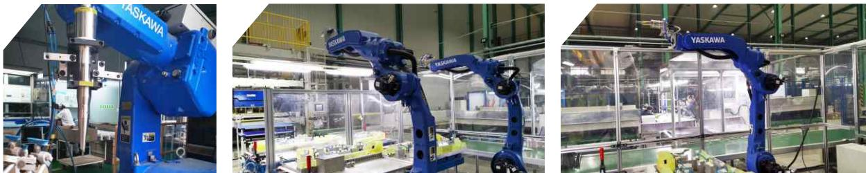
超声波切割近年来在汽车塑料件和橡胶行业获得了广泛应用。超声波切割刀可精确切割汽车塑料水口件、橡胶、热塑性薄膜、各种热熔性材料。其中既包括手持设备，也有集成到自动化机器中的各类系统。超声振动刀的优势在于：切割精确、无压切割（可避免软质切割物变形）、特定材料边缘切割的同时可进行焊接、切割速度快以及可明显降低清洗成本。
