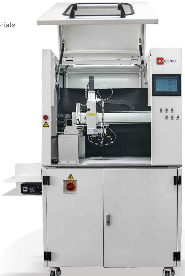
超声波精密喷涂机，采用发明专利的超声波喷头技术，可提供均匀高效的薄膜喷涂及喷雾热解，膜厚最薄可达几十纳米。适用于薄膜太阳能电池、燃料电池、半导体光刻胶、传感器、PCB助焊剂、织物功能涂层、玻璃镀膜等多种纳米及亚微米级薄膜制备。
