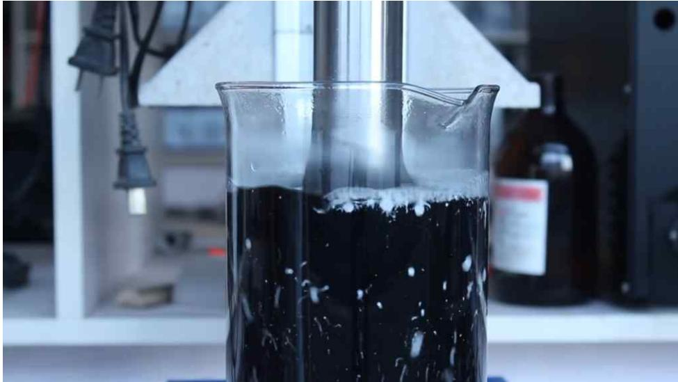
当以高强度超声处理液体时，传播到液体介质中的声波导致产生交替的高压（压缩）和低压（稀疏）循环，其速率取决于频率。在低压循环期间，高强度超声波在液体中产生小的真空气泡或空隙。当气泡达到不能再吸收能量的体积时，它们在高压循环期间剧烈塌陷。这种现象称为空化现象。在内爆期间，局部达到非常高的温度（约5,000K）和压力（约2,000atm）。空化气泡的内爆也导致液体射流速度高达280 m/s。超声空化引起的物理化学变化，可应用于石墨烯制备。
