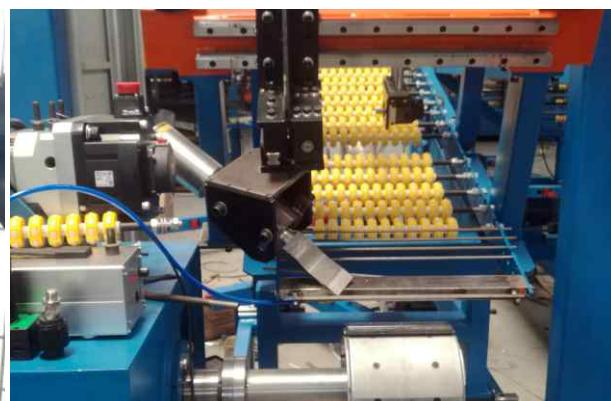
汽车轮胎内衬切割生产线
