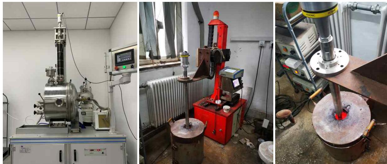
超声波晶粒细化 Ultrasonic grain refinement
