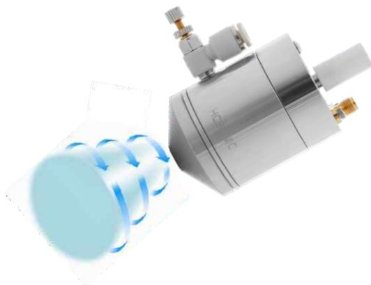
旋涡喷涂系统利用HCSONIC独特腔体设计，利用快速的旋转气流，可产生较阔且稳定的喷雾束。通过调整雾化头与工件的距离，旋涡喷嘴可产生可调直径之圆锥形喷雾束。
