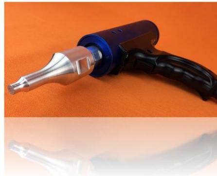
超声波焊接主要应用在两大范围：家电和汽车内装饰，对于大型产品的焊接就需要用专业的超声波焊接机。具体包括：汽车门板、汽车隔音板、汽车内饰件、汽车隔音棉、电视机外壳、电脑外壳、电器塑料饰件等，详细的工艺及材料：适用于ABS、PP、PE、PC、PUC、PMMA、PS、PPS、PBT、PETG等塑料质的点焊、压焊、铆焊和链焊工艺。
