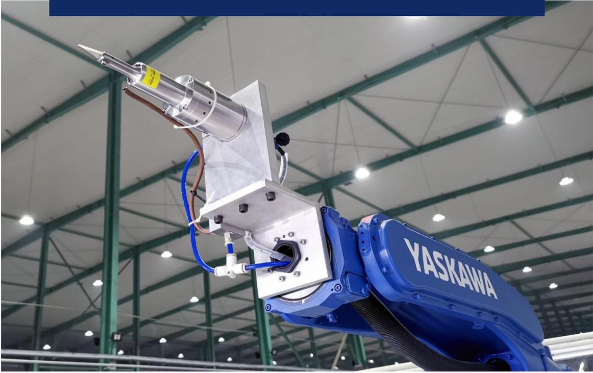
超声波切割近年来在汽车塑料件和橡胶行业获得了广泛应用。超声波切割刀可精确切割汽车塑料水口件、橡胶、热塑性薄膜、各种热熔性材料。其中既包括手持设备，也有集成到自动化机器中的各类系统。
